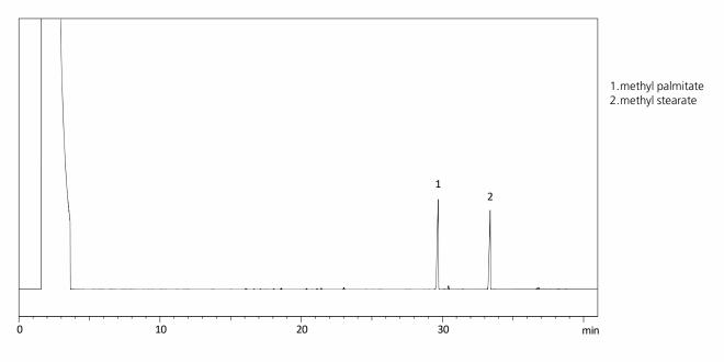
Column : SH-PolarWax 30 m x 0.32 mm l.D., df= 0.5 µm, P/N : 227-36251-01
