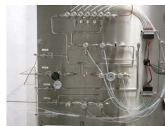
Obrázek 3 Automatizovaný, dokonale těsný vzorkovací panel pro bezpečnou analýzu pyroforického silanu.
