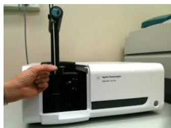
Obrázek 1 Přístroj Cary 60 vybaven optickým vláknem při měření 150 \mu l DNA v mikrozkušavce
